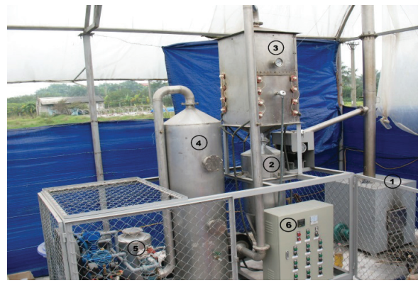
Hệ thống đốt than, xử lý, thu gom, làm sạch khí và nuôi tảo tại Cổ Nhuế và Thạch Bàn (1: lò đốt than; 2: xyclon khử bụi; 3: hộp xúc tác - hấp phụ; 4: tháp hấp phụ; 5: thiết bị nạp CO 2 cao áp; 6: tủ điều khiển; 7: bể nuôi Spirulina)
